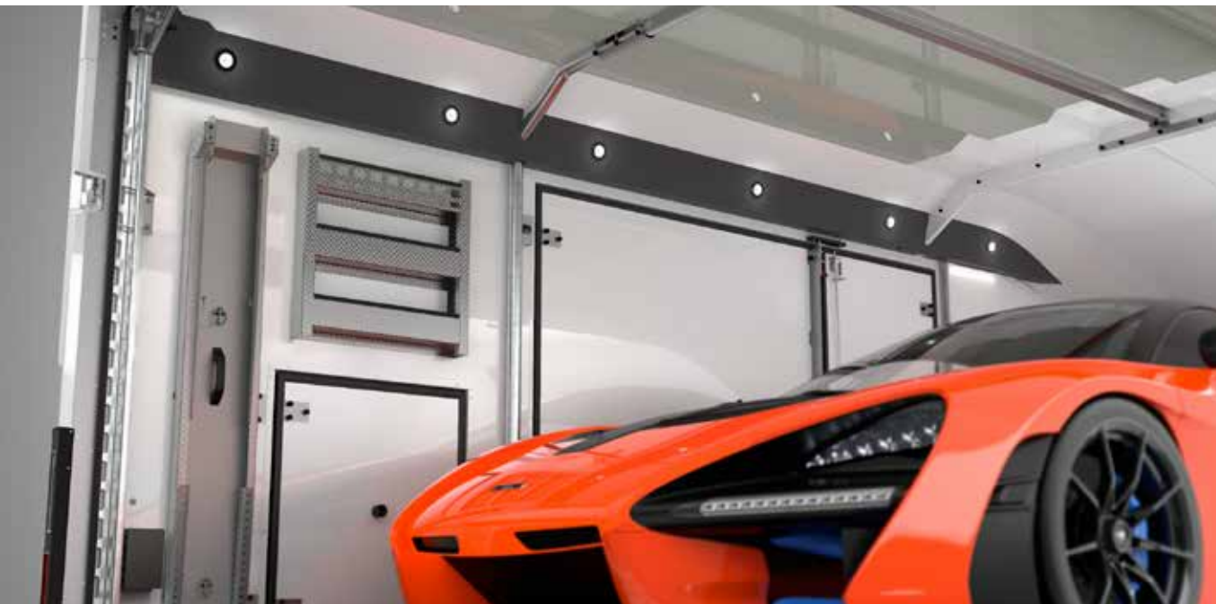
○ LED Innenraumbeleuchtung PLUS 10 LED Spots mit Stromversorgung über die Bordbatterie sorgen für eine perfekte Ausleuchtung des Laderaums.
